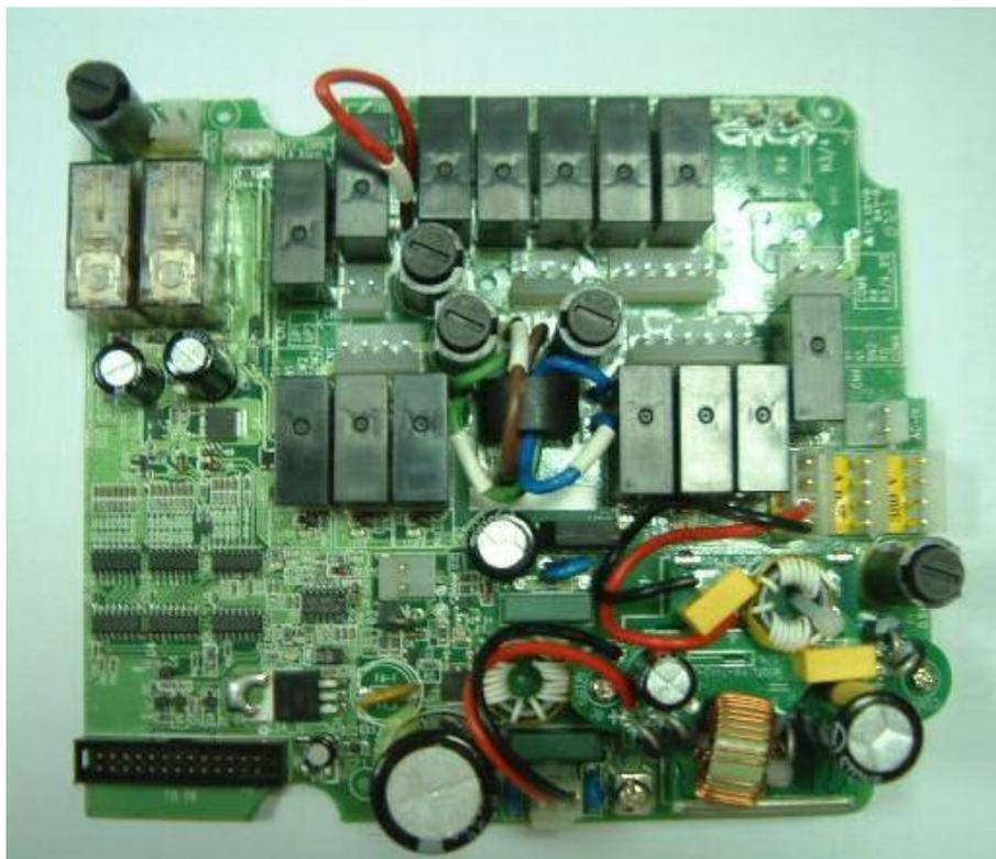
Примечание: 4-контактный разъем необходимо подключить в разъем на плате блока радиуправления наименьшего напряжения. Пример: на плате блока радиуправления 3 4-контактных разъема: 110В, 220В, 380В. Необходимо подключить 4-контактный разъем конвертера DC-DC в разъем 110В на плате блока радиуправления.
